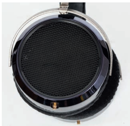
Od zewnątrz muszle zabezpieczono czarną, perforowaną siateczką. HE-6 to słuchawki otwarte, bez izolacji od źródeł hałasów.
